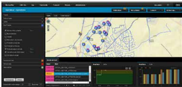
Copie d'écran de la plate-forme collaborative présentant le suivi du réseau d'eau potable.
